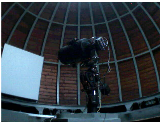
Rysunek 3.4. Teleskop ustawiony do wykonywania zdjęć flatfield na ekranie oświetlonym światłem rozproszonym.
